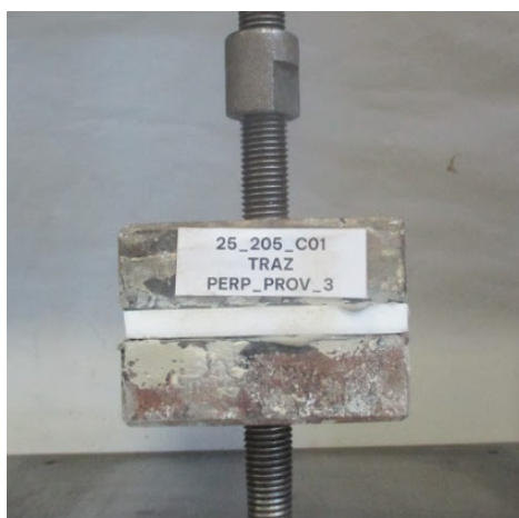
Figura 1. Immagine del provino n°3 durante la prova di resistenza a trazione perpendicolare alle facce
